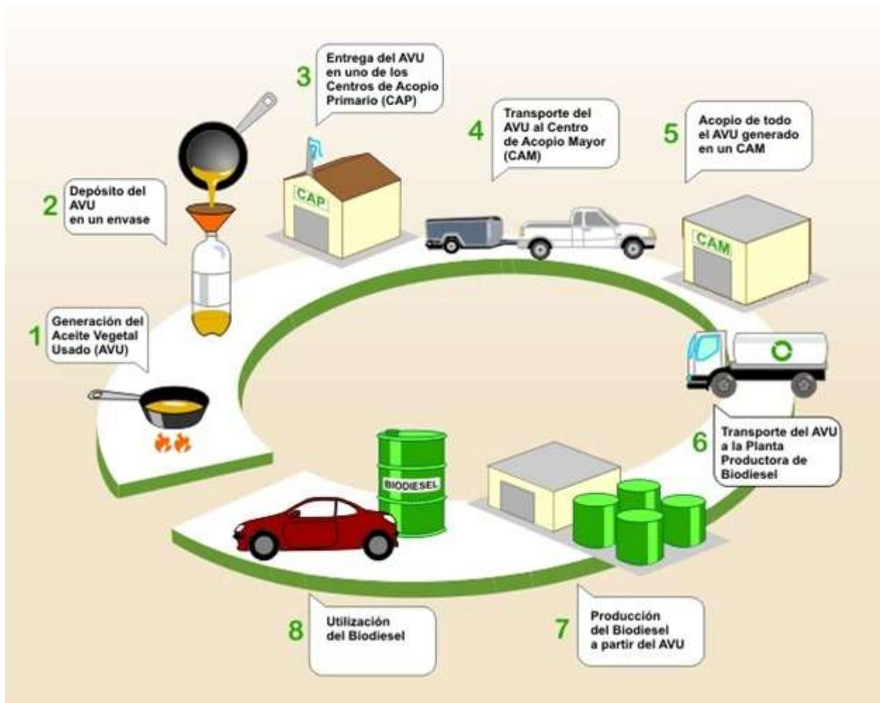
**Figura 4.** Proceso para la recolección e utilización del aceite vegetal reciclado.
