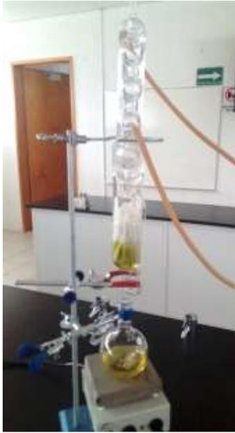
**Figura 22.** Destilación Soxhlet.
