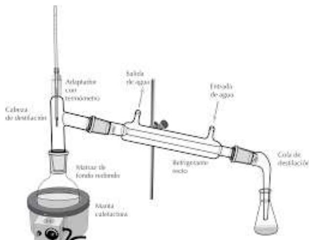
**Figura 9.** *Proceso de destilación simple.*
