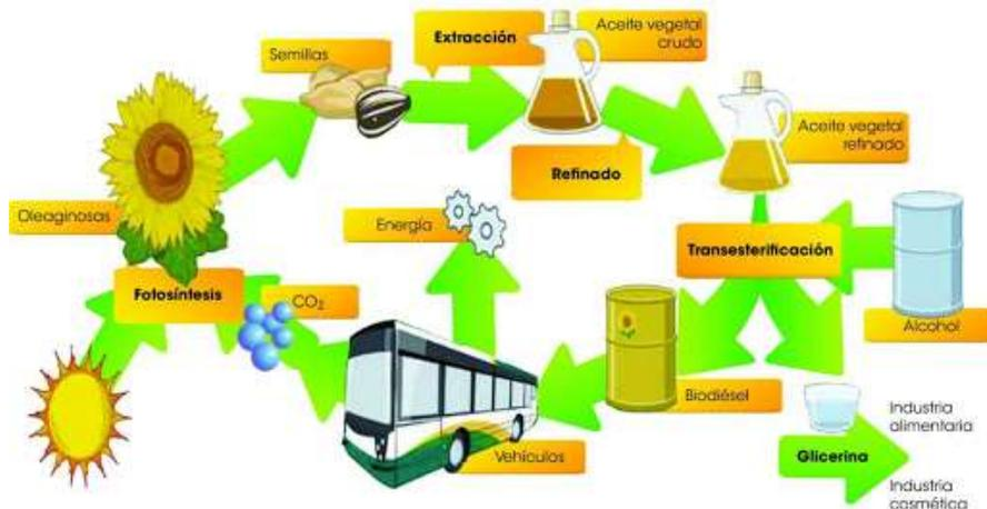
**Figura 6.** Ciclo del biodiesel.
