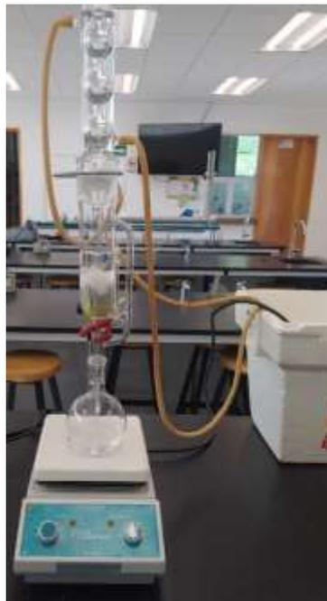
**Figura 7.** Equipo Soxhlet en extracción de aceitilla amarilla.
