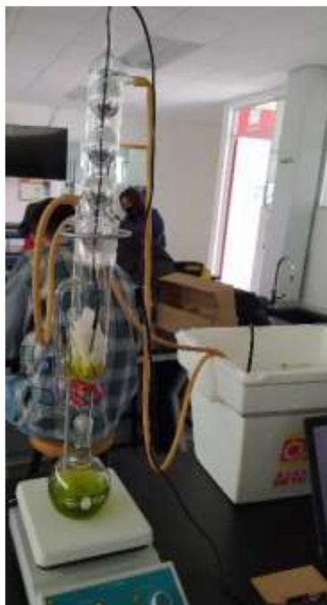
*Figura 24. Sensor colocado en el equipo soxhlet (cable negro)*
