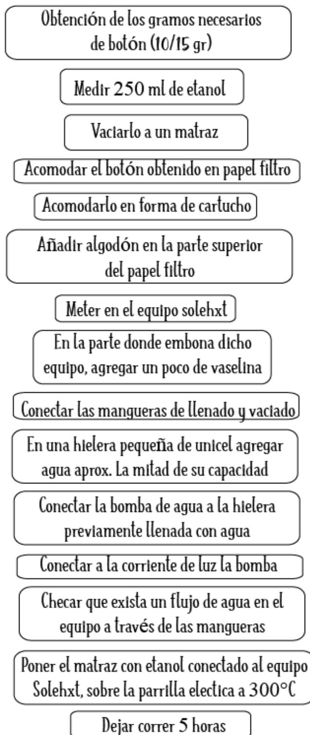
**Figura 27.** Diagrama de flujo de la extracción de la aceitilla amarilla.
