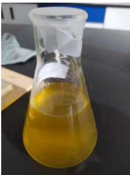
**Figura 8.** Aceite vegetal extraído de aceitilla amarilla por medio del equipo soxhlet.
