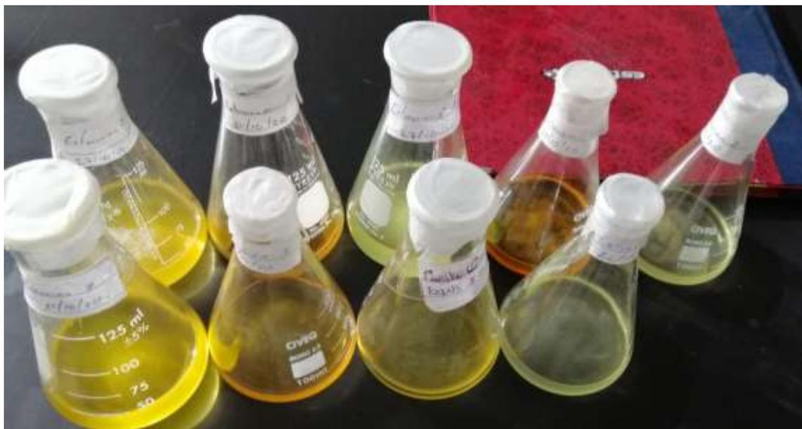
**Figura 26.** Extracciones bajo el diseño Taguchi, podemos observar la diferencia entre los colores debido a las especificaciones y el tipo de aceitilla.
